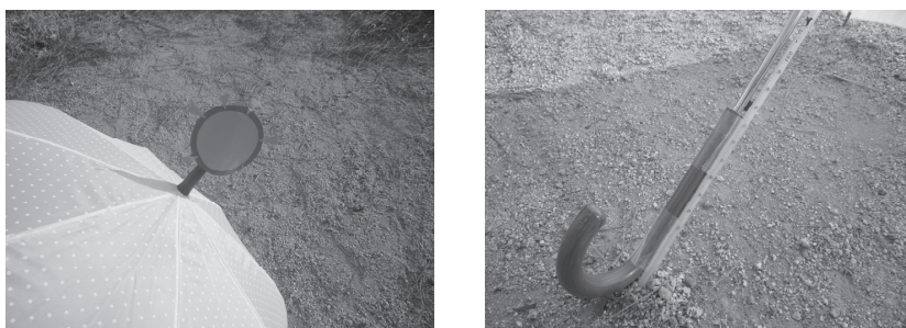
図 11 提案する教具（左写真：傘の先端の太陽模型、右写真：傘の柄に設置した温度計）
